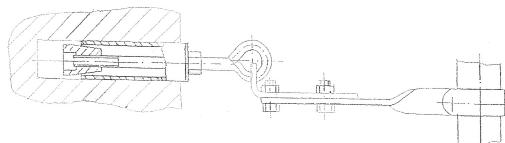
*Схема крепления лесов к стене*
